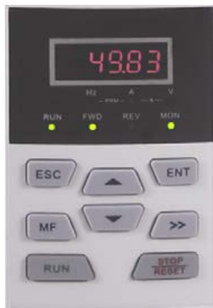
Рис.4-6 Режим установки значения параметра (b0-02 установлено на 49,83 Гц)
