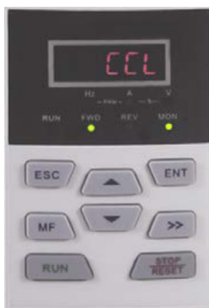
Рис.4-4 Состояние отображения неисправности или тревоги (CCL: Contactor act fault – Ошибка срабатывания контактора)
