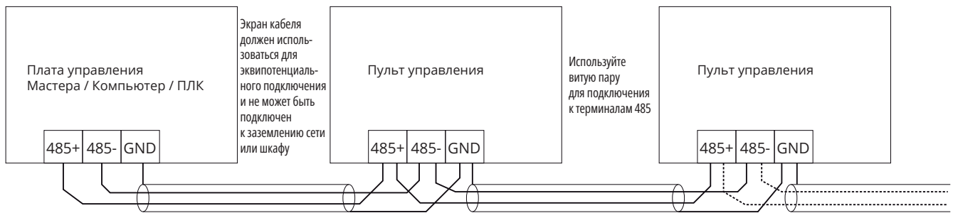
Рис.3-26 Схема подключения коммуникационного терминала RS485
